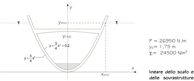
sia di 26950 N e che il baricentro G si trovi a 1.75 m dalla generatrice inferiore della chiglia, determinare la posizione del piano di galleggiamento per cui vi è equilibrio e l'altezza
