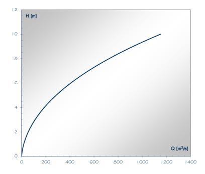
7. Per lo stramazzo in parete sottile (stramazzo Bazin) con L=1 m rappresentato in figura sono stati determinati sperimentalmente i valori di portata riportati nella tabella seguente in funzione del carico H:
