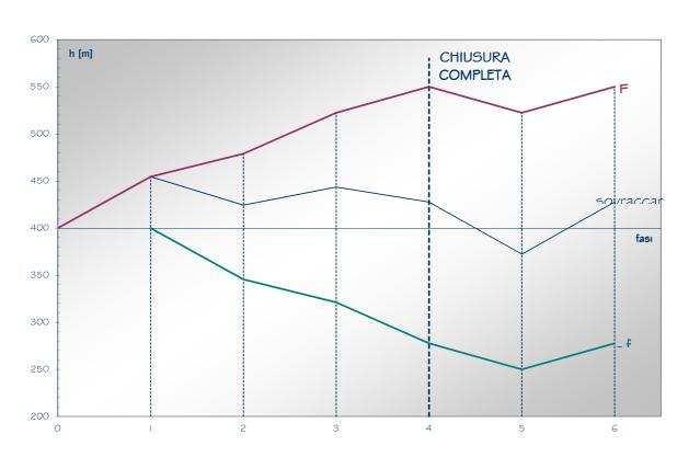
Adesso per ottenere l'andamento delle F e delle f nella sezione di mezzeria basta sfasare in ritardo di  $\frac{1}{4}$  di fase la F e in anticipo di  $\frac{1}{4}$  di fase la f:
