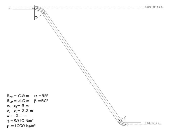
Per determinare la spinta esercitata dal fluido in movimento sui raccordi delimitati dai punti A-B e C-D sull'asse della condotta è necessario applicare l'equazione di equilibrio globale della dinamica:
