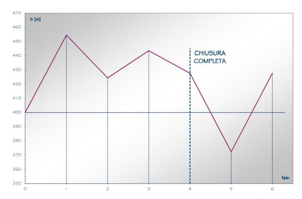
Confrontiamo il massimo sovraccarico ottenuto con la formula di Michaud. È possibile farlo perché la chiusura avviene fra le  $4 \div 8$  fasi e il massimo valore di sovraccarico si ottiene al termine della prima fase:
