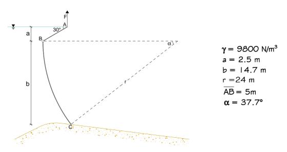
Calcolare con riferimento ad una lunghezza unitaria le seguenti forze: la spinta sulla paratoia piana AB, lo sforzo F sul tirante ammettendo la paratoia AB incernierata in B. Per ultimo determinare la spinta sulla paratoia a settore BC.
