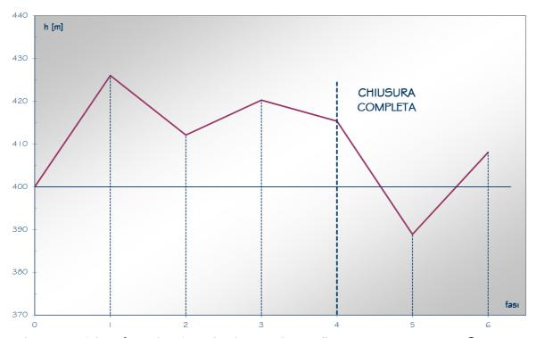
Si può notare dal grafico che dopo la chiusura le oscillazioni sono smorzate. Questo perché c'è ancora un passaggio di acqua attraverso la sezione  $\omega_0/2$ . Quindi il sistema tende a riportarsi a regime con la nuova sezione di passaggio.
