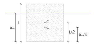
Per determinare il **grado di affondamento** è necessario imporre la condizione di galleggiamento, che si ottiene eguagliando la spinta di Archimede S, che dipende dal volume immerso, al peso del corpo P:
