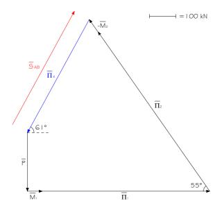
Per determinare la spinta dell'acqua sul raccordo è possibile fare una somma dei vari vettori per componenti, cioè stabilire un sistema di riferimento globale al quale riportare tutti i vettori e ricavare le risultanti delle componenti orizzontali e di quelle verticali delle forze, note le quali
