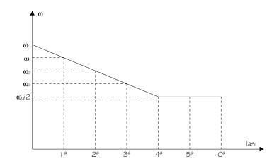
Calcoliamo ora i sovraccarichi nella sezione finale dell'otturatore per sei fasi in seguito ad una chiusura lineare parziale da  $\omega_0$  a  $\omega_0/2$ , completata per un tempo  $\tau$  pari a quattro fasi.
