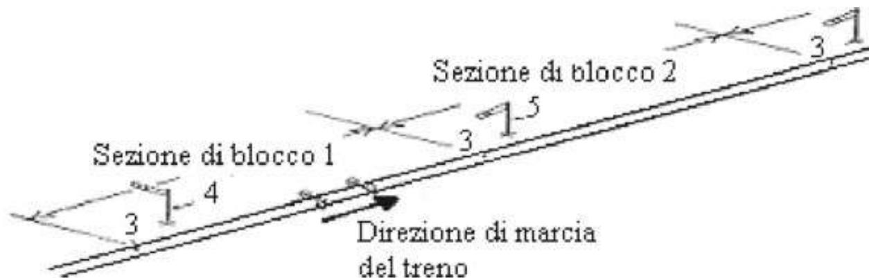
Dispositivi di blocco automatico: 1 e 2 sezioni di blocco; 3 giunti isolanti; 4 segnale di ingresso nella sezione 1; 5 segnale di uscita dalla sezione 1 e di ingresso nella sezione 2.
