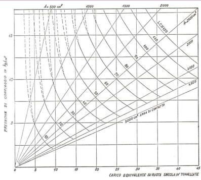
Sfruttando tale diagramma il numero LCN della pista può essere determinato in base ad una coppia di valori (A, Q) relativa ai risultati delle prove di carico. Q è IL CARICO DI SICUREZZA
