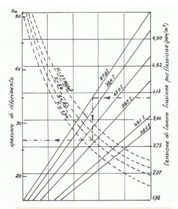
Determinazione di s<sub>1</sub> per l' aereo B727-200 in funzione di K (modulo di reazione del sottofondo) e del carico dell'aereo
