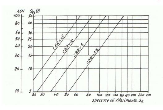
Determinazione dell' ACN in funzione dello spessore di riferimento s<sub>2</sub> e dell' indice CBR
