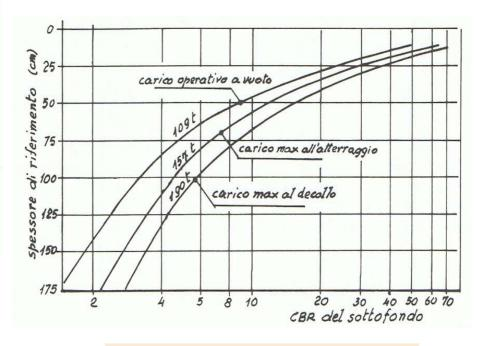
Determinazione di s<sub>2</sub> per l' aereo DC 10-10 in funzione del CBR del sottofondo e del carico dell' aereo
